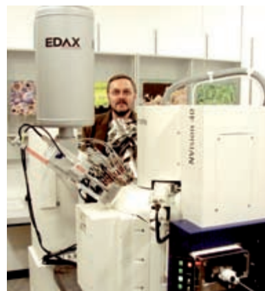
Roger Wepf hinter dem FIB-Rasterelektronenmikroskop, mit welchem die Viren (oberes Bild) aufgenommen wurden. (Bild EMEZ/ETH Zürich)
